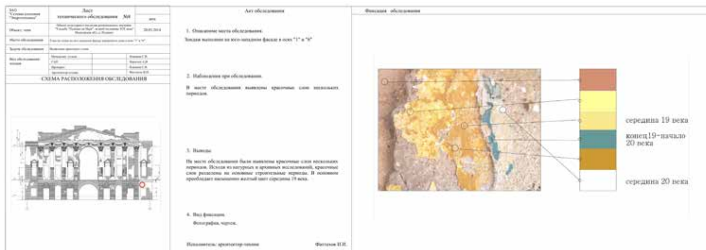
Ил.10. Исследования колористического решения стен. Зондаж выполнен на главном доме усадьбы Пушино-на-Наре
